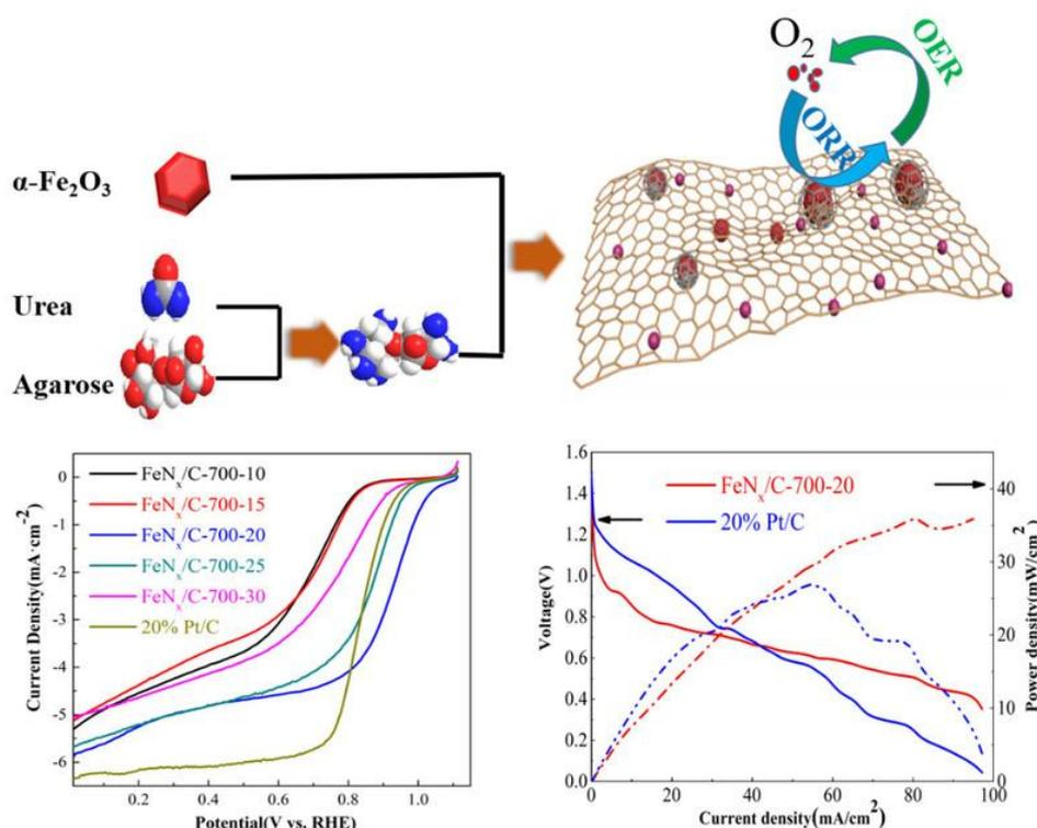
催化剂制备示意图及电催化和电池性能图
